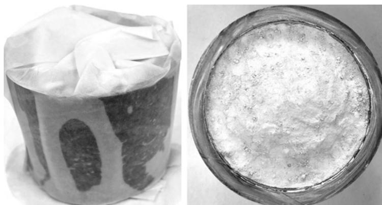
**Рис. 1.** Образец, обернутый в фильтровальную бумагу, пропитанную соевым раствором, и образец в эксикаторе с мелкодисперсной средой
